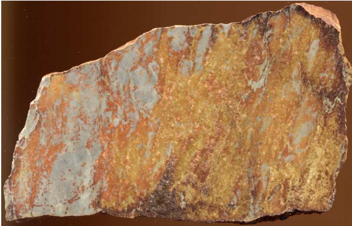
Siderit in verschiedenen Brauntönen (bedingt durch unterschiedliche Anwitterung) mehr oder weniger eng mit Ankerit (grau) verwachsen. Dichte des Rohstückes 3.31 g/ml, das entspricht einem Eisengehalt von etwa 26 %.
