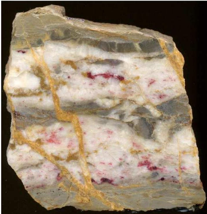
Dolomit-Quarz-Ader mit Cinnabarit, beidseitig flaseriger, grauer Kalkstein; Die Ader wird von jüngeren Karbonatadern durchschlagen.
