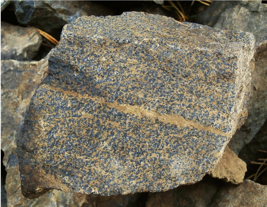
Dunit mit eingesprengtem Chromit vom Hang gleich neben der Forststraße im Sommergraben bei Kraubath. Punkt 2, Bildbreite ca. 14 cm, Fund 22.10.2023.
